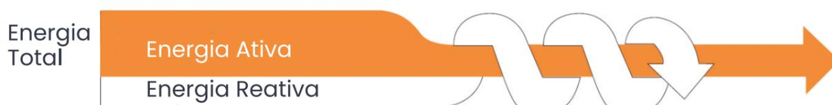
A primeira delas, **a energia reativa, medida em kVarh, não realiza trabalho efetivo,** mas é necessária e consumida na geração do campo eletromagnético responsável pelo funcionamento de motores, transformadores e geradores.
